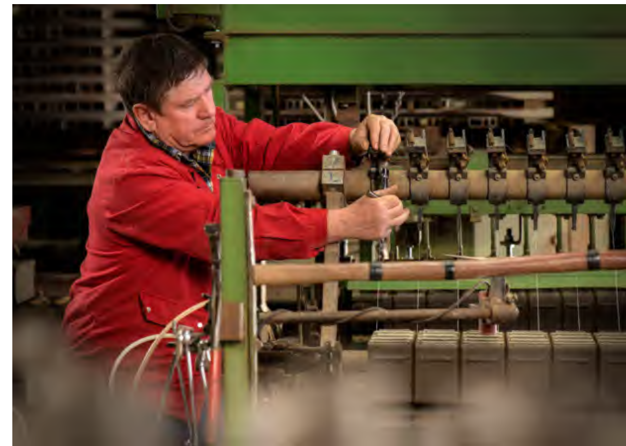
Die Klinkerrohlinge werden maschinell auf die gewünschte Dicke geschnitten.
