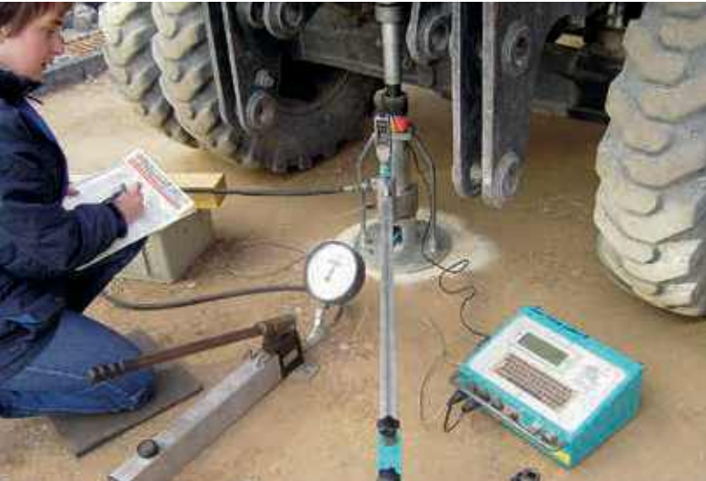
Statischer Plattendruckversuch zur Bestimmung der Verformbarkeit und Tragfähigkeit des Bodens
