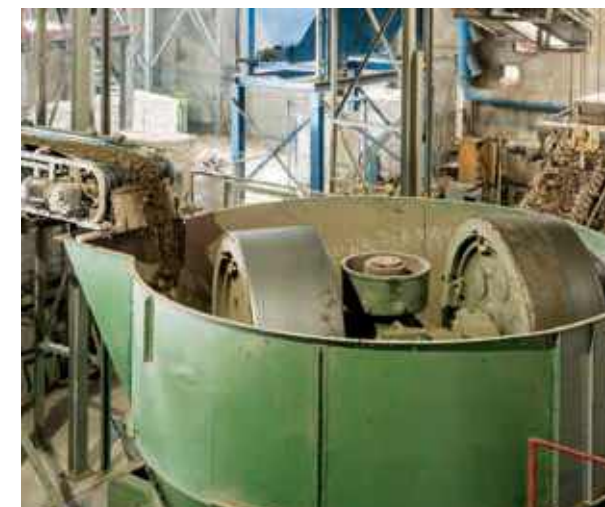
Kollergang, zwei schwere Walzen zerkleinern den Ton
