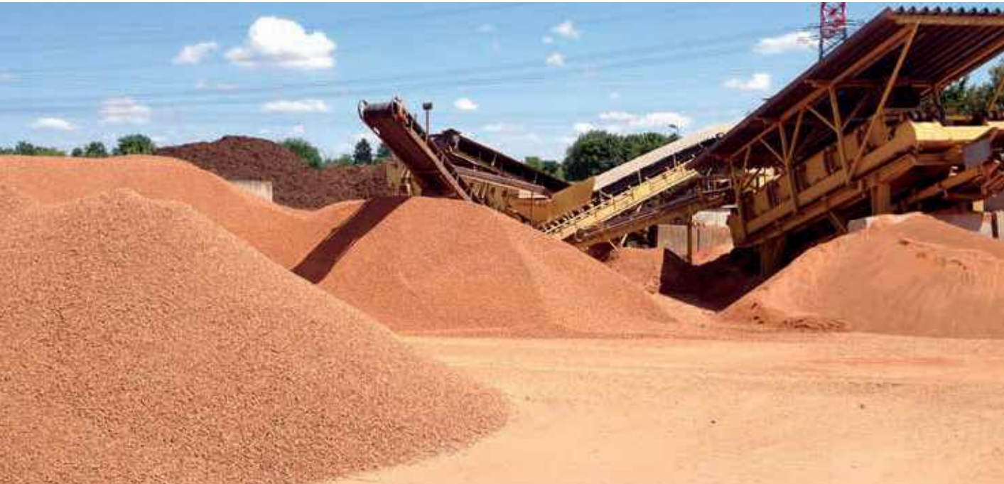
Herstellung rezyklierter Gesteinskörnungen zur Verwendung als Substrat im Vegetationsbau.
