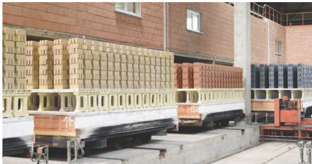
Tunnelofenwagenbesatz mit Pflasterklinker
