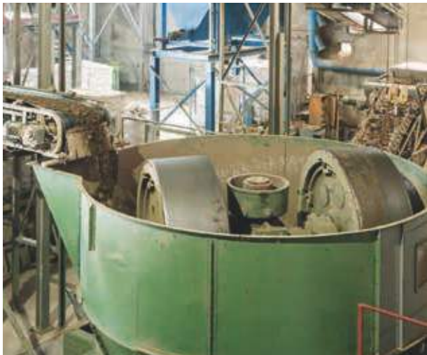
Kollergang, zwei schwere Walzen zerkleinern den Ton
