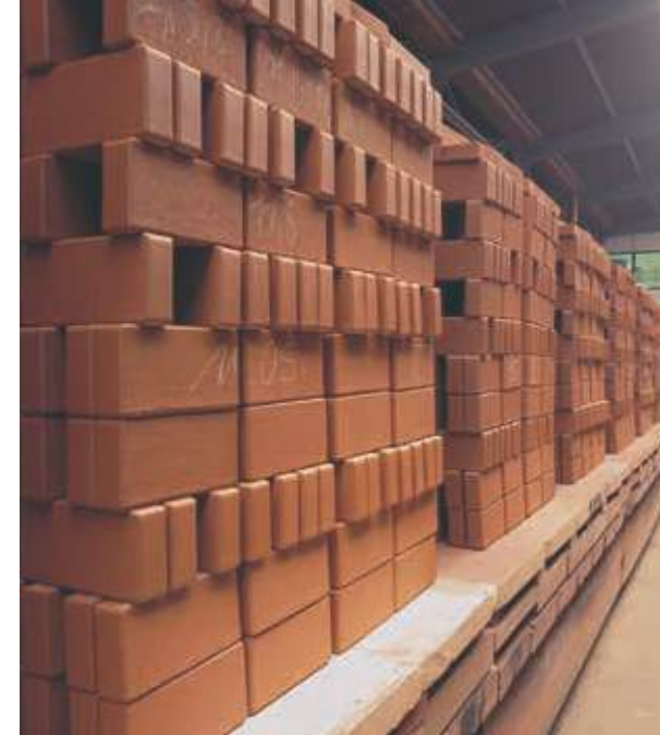
Gebrannte Pflasterklinker nach Verlassen des Ofens
